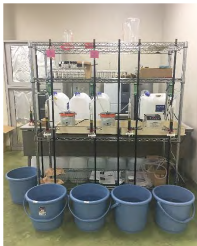
図 4. カラム吸着実験の様子
